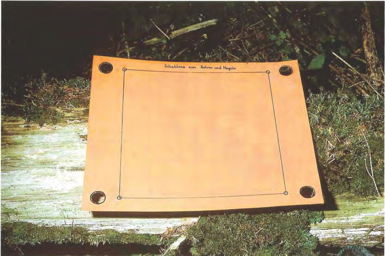
**Abb. 46:** Auf einen zufällig ermittelten 20 cm-Maßbandabschnitt eines Totholzstammes aufgelegte Eckpunktschablone; hier wurden später Aluminiumnägeln eingeschlagen.
